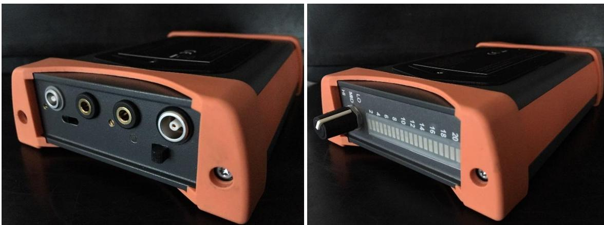
Der Empfänger ist in einem robusten Aluminium Profil Gehäuse eingebaut, welcher durch einen Stossschutz geschützt wird. Auf der Frontseite befinden sich die Bedienelemente und die Anzeige. Auf der Rückseite befinden sich weitere Bedienungs- und Einstellungselemente sowie alle Anschlüsse.
